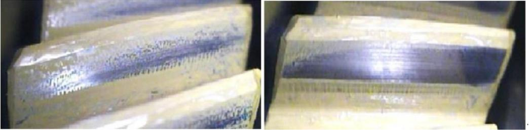
b)  $M_{MOT} = 0$  Nm a 20 Nm,  $1^\circ$  driven (Schaltrad), left side
