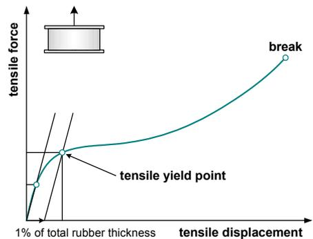
Fig. 6. Tensile properties
