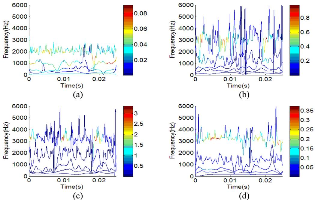
**Figure 3.** Hilbert spectrum of (a) normal (b) inner-race fault (c) outer-race fault (d) rolling element fault.
